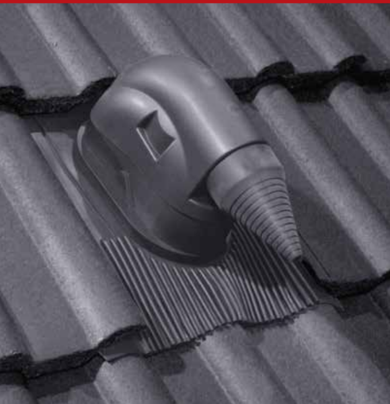
1 Regenkragen 2 Dom (für DN 110 oder DN 125) 3 Seitliche Paststreifen 4 Schürze (Standardausführung für flach bis mittel profilierte Dachziegel und Dachsteine, Decklänge 310 - 350 mm oder Ausführung mit längerer Schürze für stark profilierte Dachziegel und Dachsteine bis 60 mm, Decklänge 310 - 350 mm.
