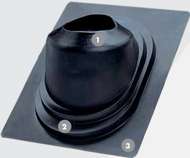
1 Flexibles EDPM passt sich an die Nennweite der Durchdringung an und sitzt selbstdichtend am Rohrschaft 2 dreistufiger Faltenbalg mit innenliegendem Einschubfreiraum 3 Breiter, umlaufender Klebeflansch
